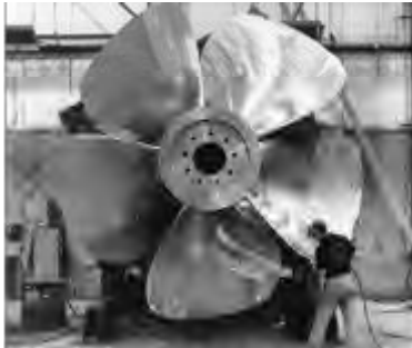
شکل ۴-۱ انواع مختلف پروانه در پمپ سانتریفیوژ - ساخت یک پروانه محوری
