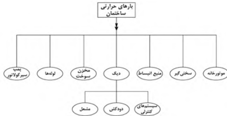
شکل ۱- فلودیاگرامی از یک موتورخانه آب گرم با منبع انبساط باز
