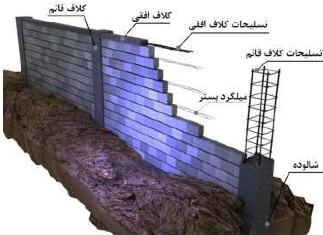
شکل ۱-۲ قسمت‌های اصلی دیوارهای محوطه بنایی
