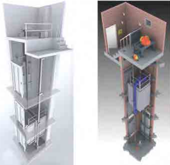
شکل (۴) - چاه آسانسور یکی از بخش‌های مهم آسانسور به شمار می‌رود.
