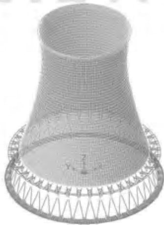
شکل ۱-۲- برج خنک کن هذلولی وار به ارتفاع ۱۳۵ متر
