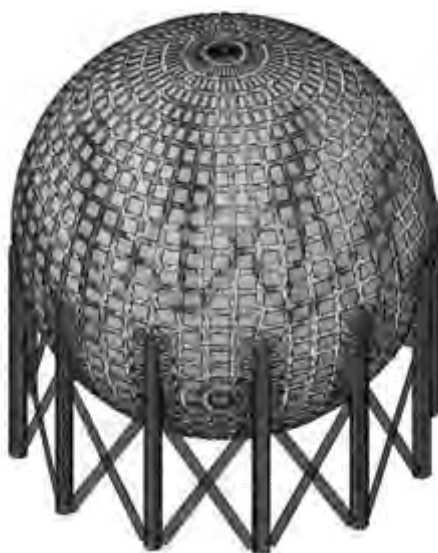
شکل ۱-۴- سازه یک مخزن بسیار عظیم کروی شکل
