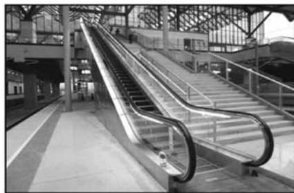
نمونه پله برقی با شیب 23.63^\circ
