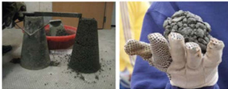
شکل ۱-۱. نمایش اسلامپ صفر برای مخلوط بتن غلتکی
