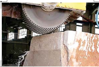
شکل ۲-۲ پرس سنگ در شخاست مورد نظر
