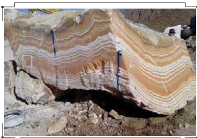
شکل ۱-۲ کوب سنگ و ساختار لایه‌ای آن
