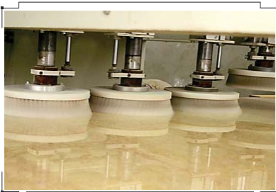
شکل ۶-۲ ساب زنی سطح سنگ بعد از رزین کاری
