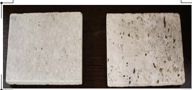
شکل ۷-۲ تغییر نمای سنگ پس از مراحل رزین و ساب
