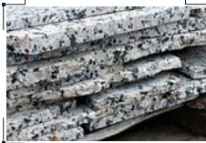
شکل ۶-۱ تفاوت محسوس در ضخامت سنگ‌ها
