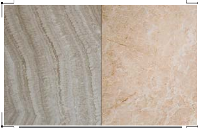
شکل ۲-۲ تفاوت ظاهری سنگ موجدار و بی موج: (سمت چپ - موجدار) (سمت راست - بی موج)
