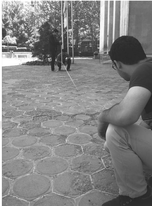
شکل ۱-۳ نحوه اجرای عملیات مترکشی
