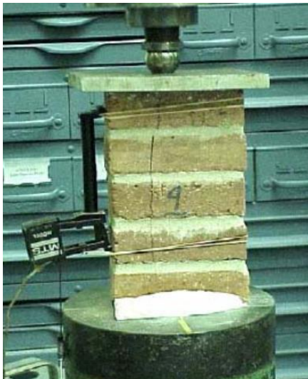
شکل ۱-۳ آزمایش تنش فشاری مصالح بر روی نمونه منشور بنایی
