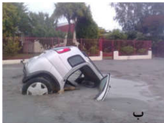
شکل ۲. الف) فرو رفتن یک ویلا بعد از روانگرایی درون خاک (ب) فرو رفتن یک ماشین کوچک و
